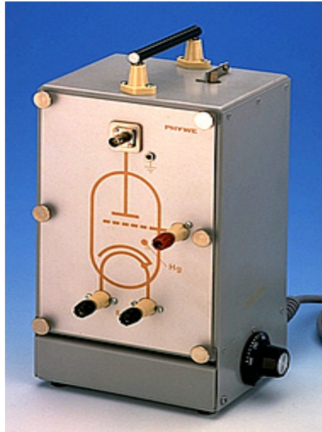
Figura 9.1: Horno de Franck y Hertz.
