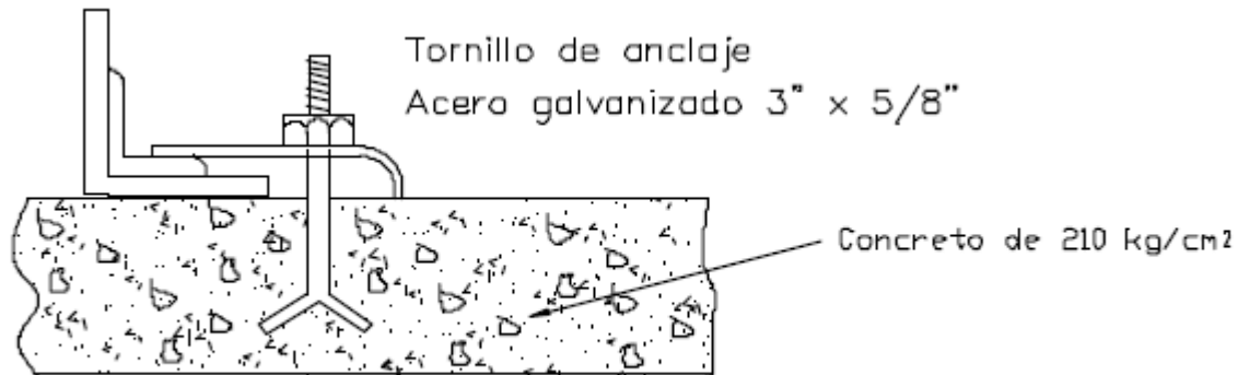
DETALLE PERNO DE ANCLAJE
